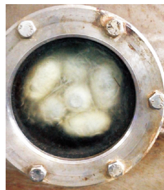
图8 减压煮茧机吐水状态
