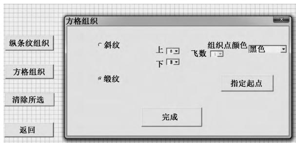
图 4 8 枚 3 飞纬面缎纹参数设置
