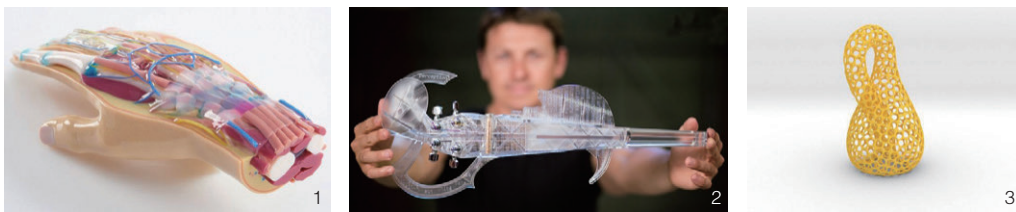
1. 医用手部模型 彩色多材料 3D 打印 2. 全球第一款 3D 打印小提琴 3Dvarius 3. 3D 打印的克莱因瓶
